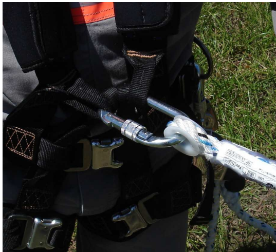
Figura 34 – Instalação do trava-quedas no cinto paraquedista
